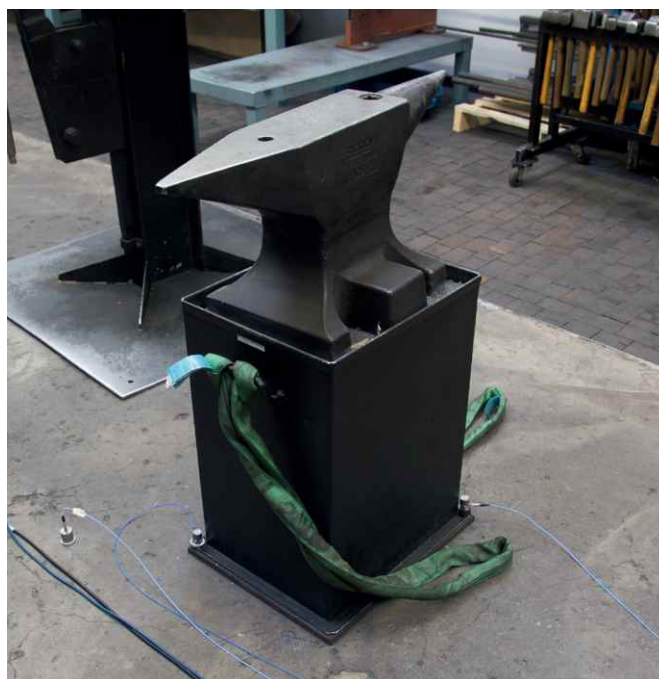
Bild 3: Anordnung der Beschleunigungssensoren in der Schmiede
