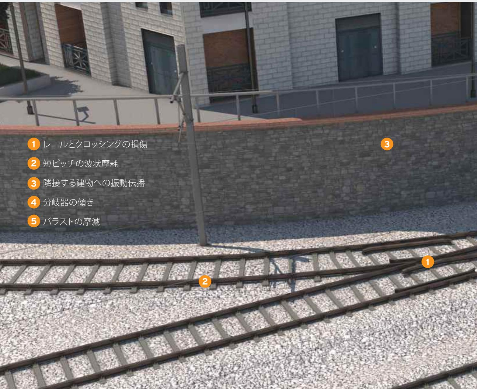
**通**過する列車の荷重は不均一に分散するため、分岐器では大きな動的負荷が生じます。その結果、様々な要因によりメンテナンスコストが増大します。例えば、バラストが大きな負荷を受けて摩滅することでマクラギ下に空洞が発生し、分岐器全体が傾く可能性があります。さらに、クロッシングやレールのような軌道構造部品に損傷が生じる場合もあります。
