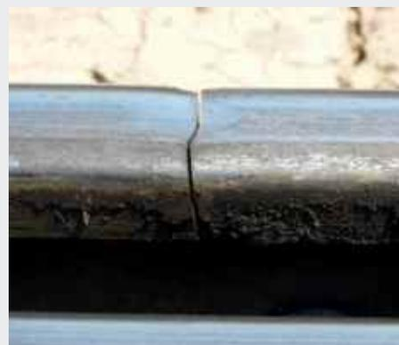
大きな動的負荷を頻繁に受けて破損したレール
