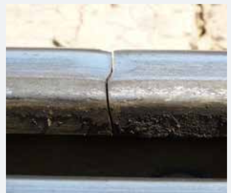
大きな動的負荷を頻繁に受けて破損したレール
