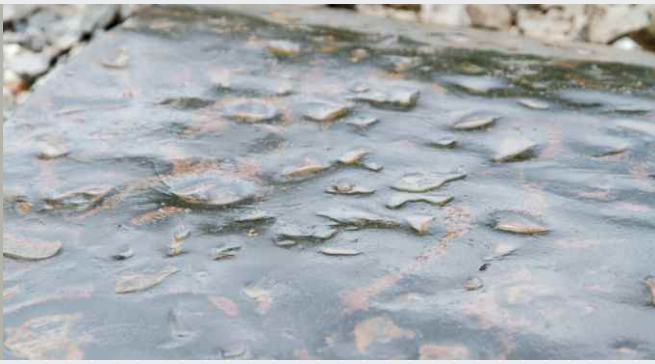
バラストマット上にみられたバラストとの接触痕
