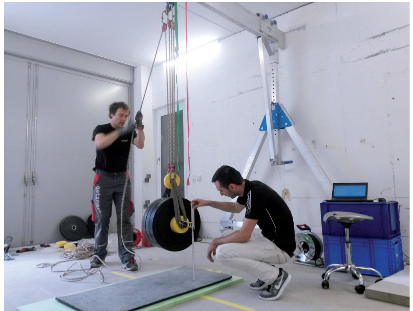
Auf unterschiedliche Bodenbeläge führte Getzner Fallversuche mit Hantelgewichten im Deckenprüfstand durch.
