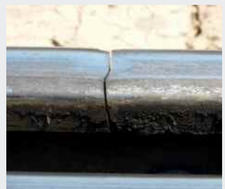
Hohe dynamische Kräfte führen nicht selten zu Schienenbrüchen.
