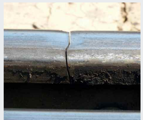
Hohe dynamische Kräfte führen nicht selten zu Schienenbrüchen.
