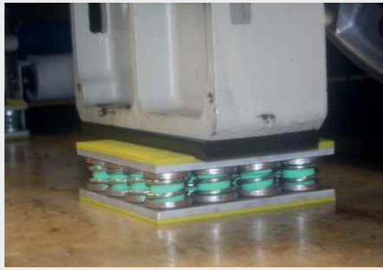
Fuß einer Textilmaschine auf Isotop® DMSN-BL (Sonderausführung)
