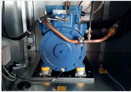
Lagerung eines Hubkolbenkompressors mit Isotop® DZE Mini
