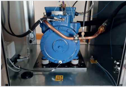
Lagerung eines Hubkolbenkompressors mit Isotop® MSN-DAMP
