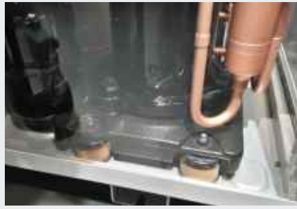
Lagerung einer Kompressorenbaugruppe auf einem Innenrahmen
