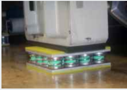
Fuß einer Textilmaschine auf Isotop® DMSN-BL (Sonderausführung)
