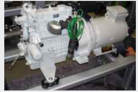
Kleines Blockheizkraftwerk auf Isotop® DMSN-BL (Sonderausführung)
