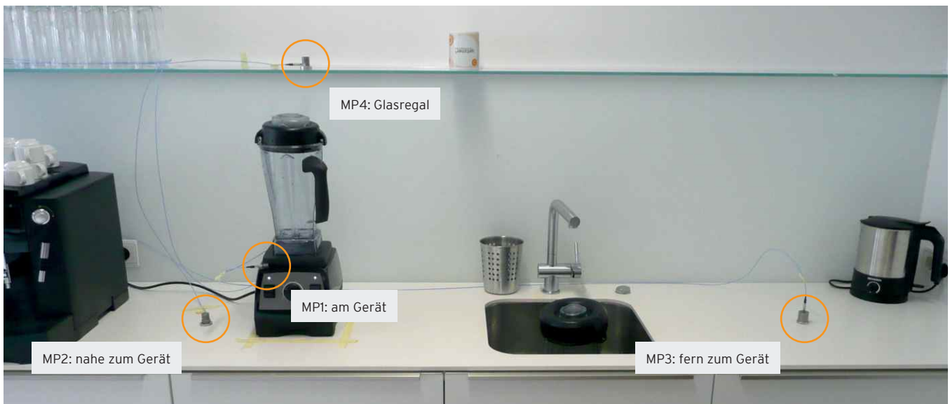
Versuchsaufbau: Anordnung der Messpunkte (MP) mit Beschleunigungssensoren
