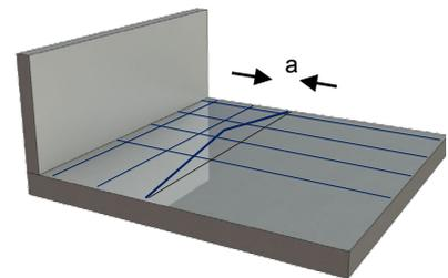
**3)** Tracer sur le radier au cordeau de traçage le futur positionnement et les espacements.
