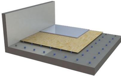
**6a)** Pour la pose de plusieurs couches de chapes sèches, il faut bien veiller à poser les plaques en décalé (croiser les joints - min.  $a/2$ ).
