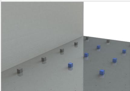
**4a)** Positionner sur le radier les types de Floor Block selon le plan de positionnement.
