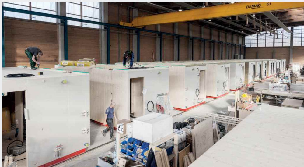
Produktion der Module mit Sylodyn® Streifenlagern
