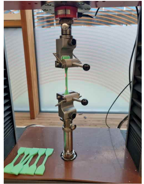
Die Überprüfung der Zugfestigkeit erfolgte nach DIN ISO 527-1.
