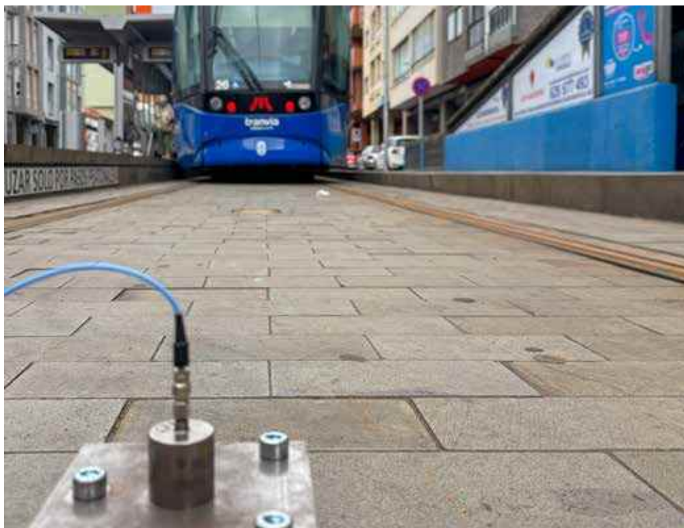
Die Eigenfrequenz der elastisch gelagerten Gleisplatten wurde nach ISO 7626-5:2019-12 durch einen Sprung auf die Platte bestimmt. Die Systemreaktion erfasste ein Beschleunigungssensor.
