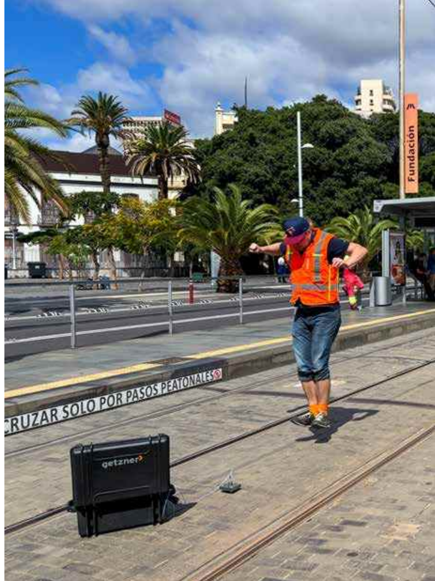
Die Eigenfrequenz der elastisch gelagerten Gleisplatten wurde nach ISO 7626-5:2019-12 durch einen Sprung auf die Platte bestimmt. Die Systemreaktion erfasste ein Beschleunigungssensor.
