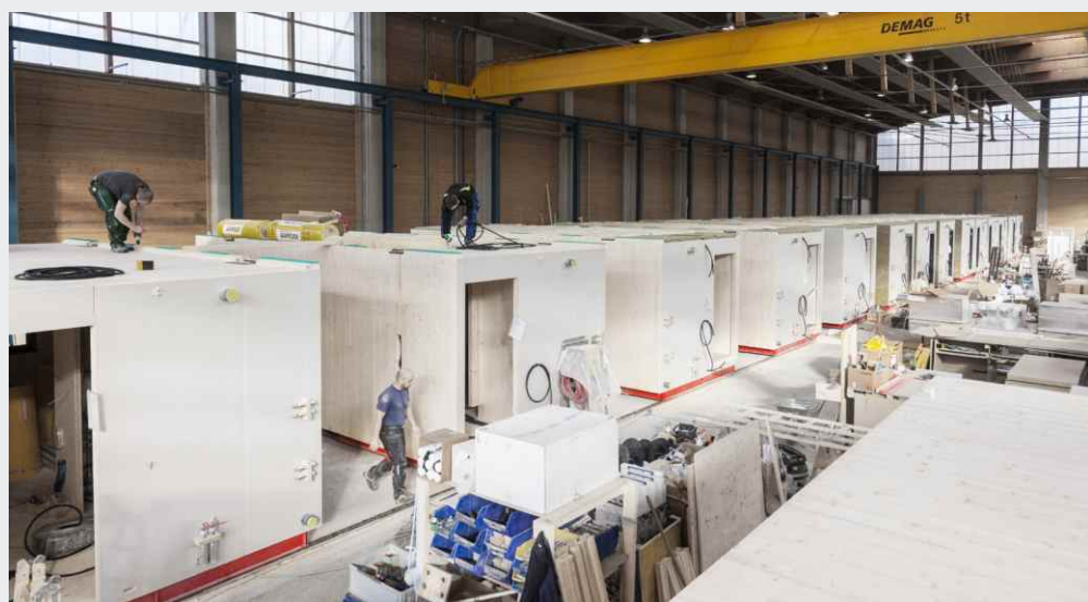
Fabrication des modules avec des appuis linéaires Sylodyn®
