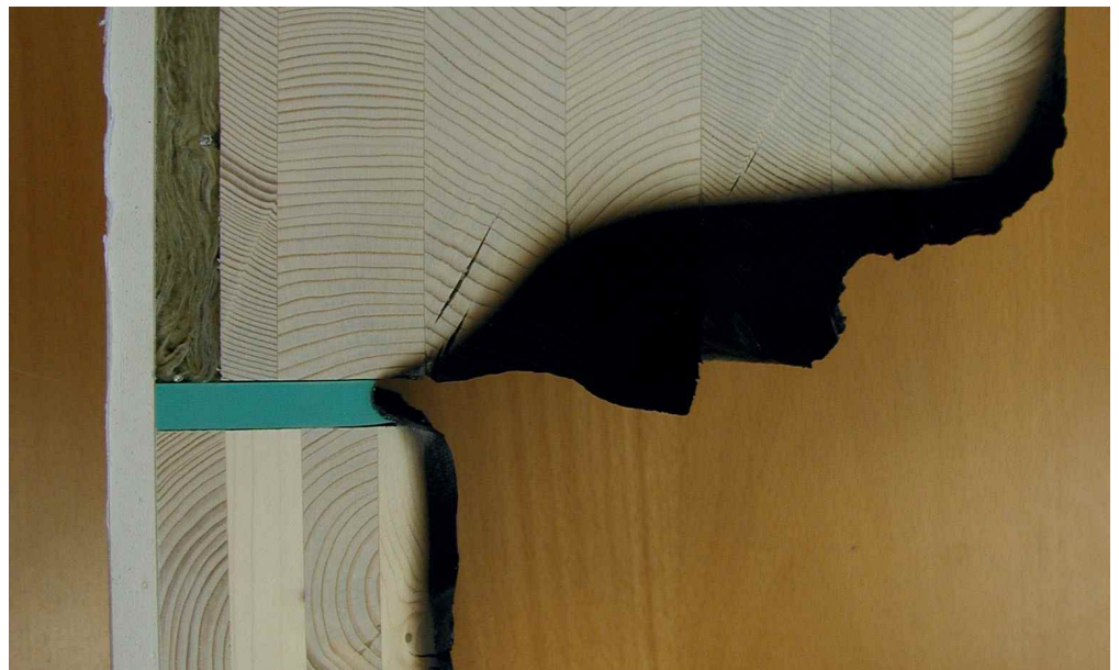
Fig. 7 : Détails des raccordements après 60 minutes de charge thermique
