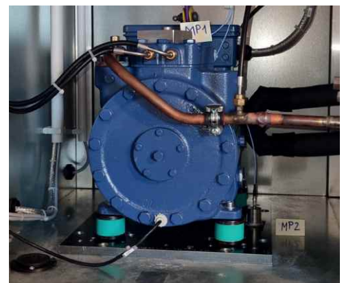
Compresseur monté sur quatre produits Isotop® MSN-DAMP
