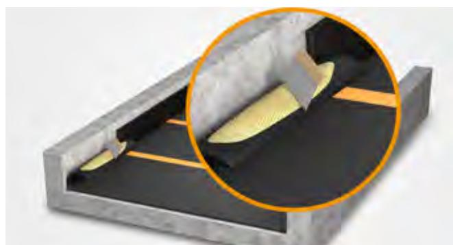
Después de la instalación, inspeccionar visualmente las juntas selladas de las alfombras. Si las juntas no están selladas correctamente, pueden ocurrir puentes acústicos, lo que podría reducir o anular completamente la efectividad del aislamiento de vibraciones. Por lo tanto, recomendamos cubrir toda la instalación con una lámina de PE transparente antes del lechado. Las mantas no deben ser transitadas por vehículos.
