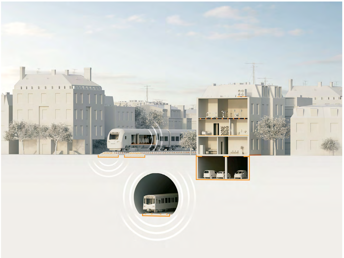
Bild 1: Schwingungsübertragung von Eisenbahnstrecken an deren Umgebung
