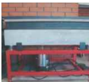
A Fußbodenplatte (Furnier) B Schwingungsisolierung C Stahlgitterrahmen D Schwingende Fahrzeugkarosserie
