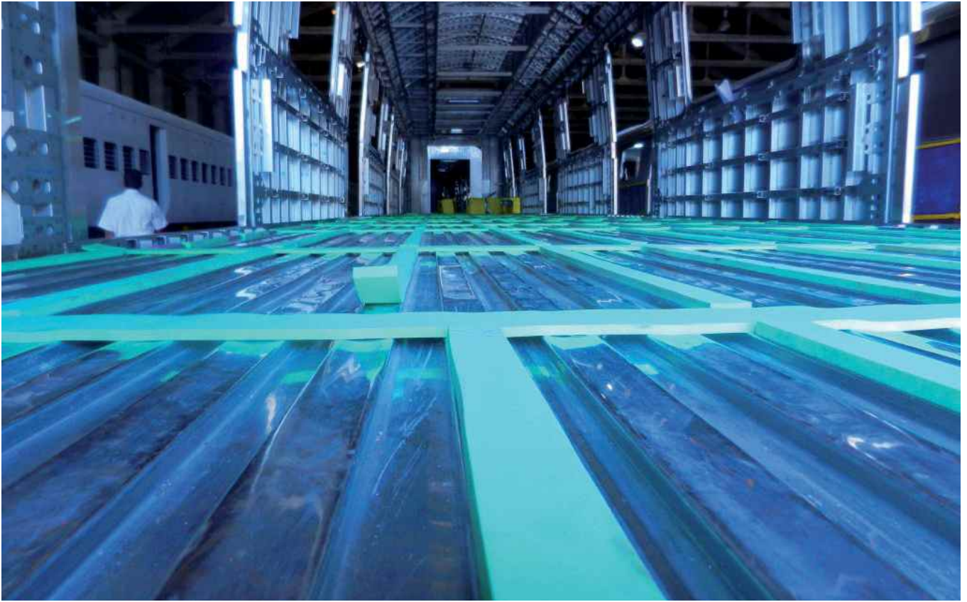
Schwingungen reduzieren mit Waggonbodenlagerungen aus Sylomer® FR
