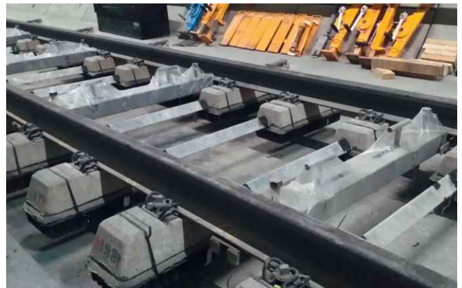
Bi-Block Schwellen mit Sylodyn®-Schwellenschuheinlageplatten
