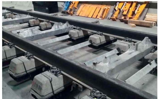
Bi-Block Schwellen mit Sylodyn®-Schwellenschuheinlageplatten
