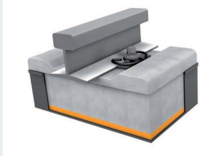
Die Auslegung der Einlagestreifen erfolgt bei Getzner mittels FEM-Methode. Getzner liefert die auf die Kundenbedürfnisse ausgelegten und konfektionierten Schwellenschuh-Einlagen für eine verbesserte und langlebige Weiche in der Festen Fahrbahn.
