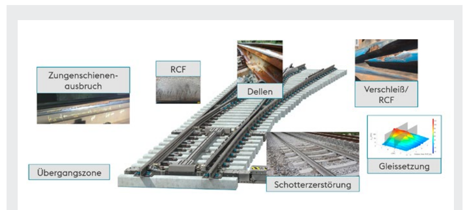
2: Schädigungsmechanismen der Weiche, die Wartung und Instandhaltung auslösen
