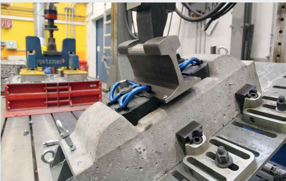
Am hauseigenen Großprüfstand werden Zwischenplatten intensiv getestet
