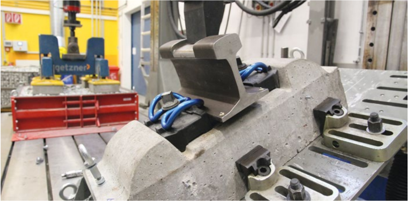
Am hauseigenen Großprüfstand werden Zwischenplatten intensiv getestet
