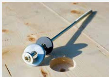
Fig. : Raccord vissé avec rondelle élastique Sylodyn® EW M8-6
