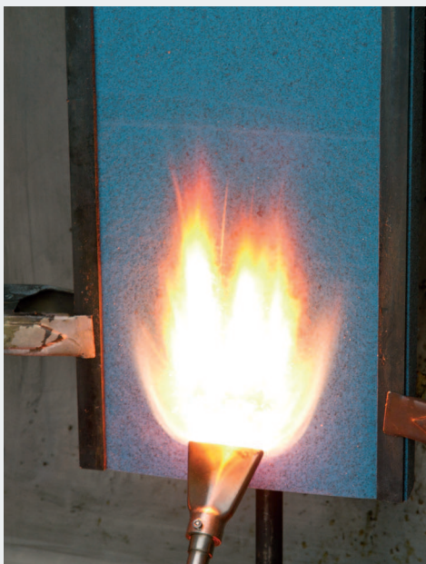
Interner Brandversuch in Anlehnung an DIN 5510-2
