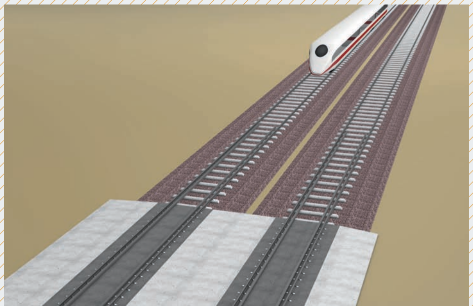
Übergang von Schotteroberbau auf Feste-Fahrbahn
