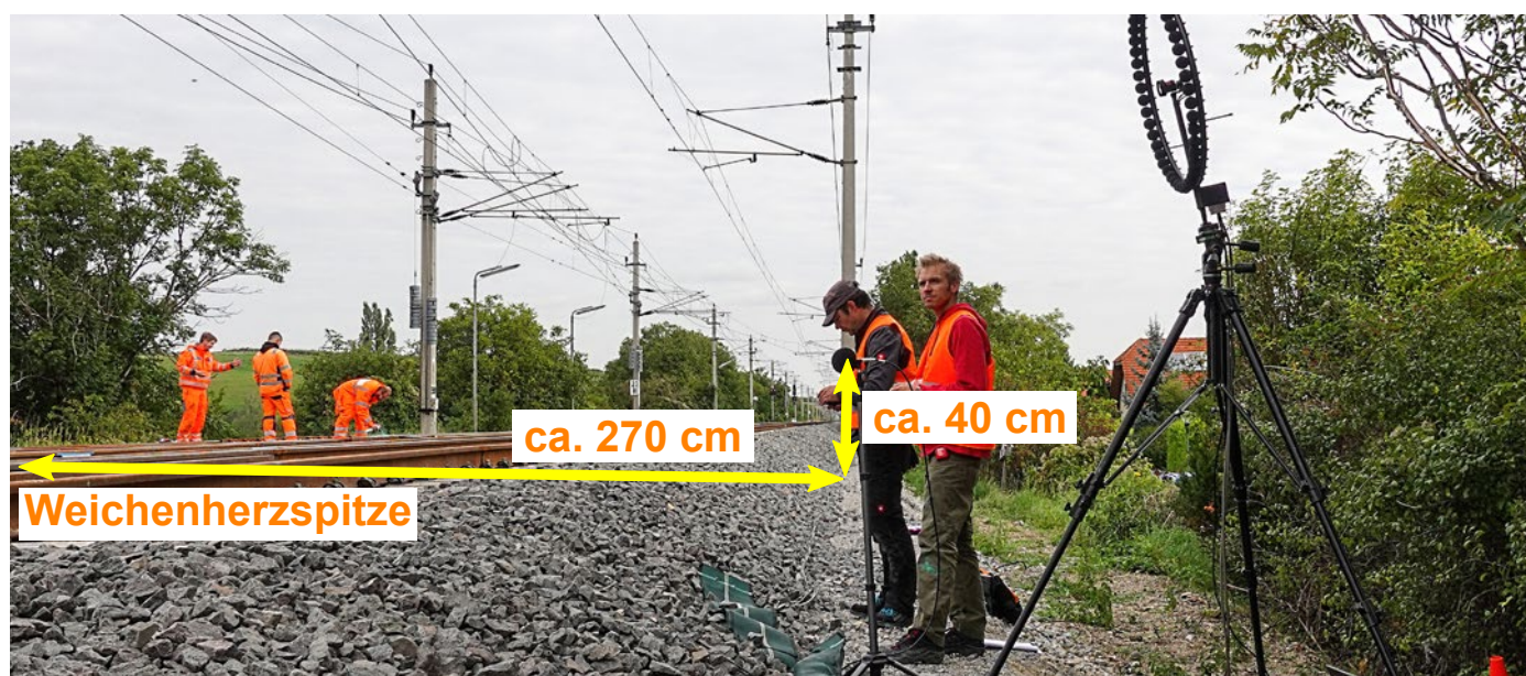
Abb. 8: Messaufbau der Vorbeifahrtsmessung in Pfaffstätten
