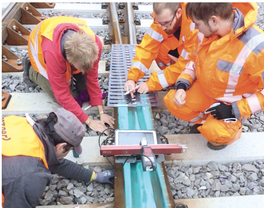
Abb. 7: Vermessung der Weichenherzgeometrie durch die vaRS
