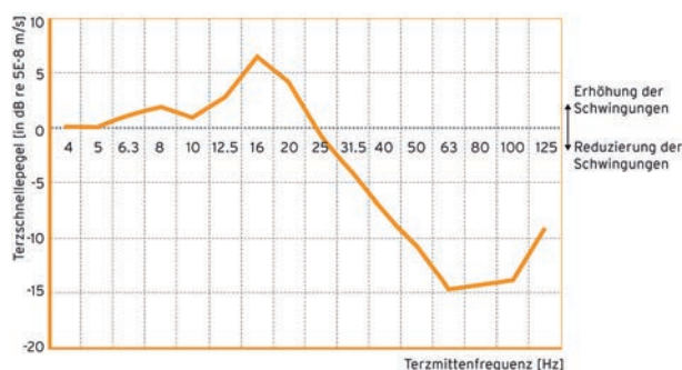
Bild 9. Dämmwirkung der elastischen Gebäudelagerung
