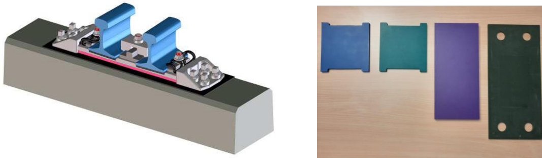
Abb. 8: ERL NG mit aufeinander abgestimmten PUR-Elastomeren (Herzstückbereich - beispielhafte Ausführung mit zwei Schienen und Klemmplatte)
