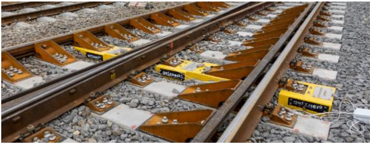
Abb. 14: Einbauzustand und Messung im Shift2Rail Projekt
