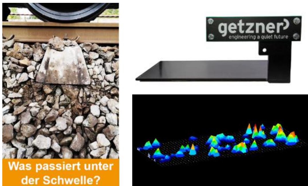
Abb. 12: Drucksensoren erfassen positionsabhängig die Lastabtragung im Oberbau
