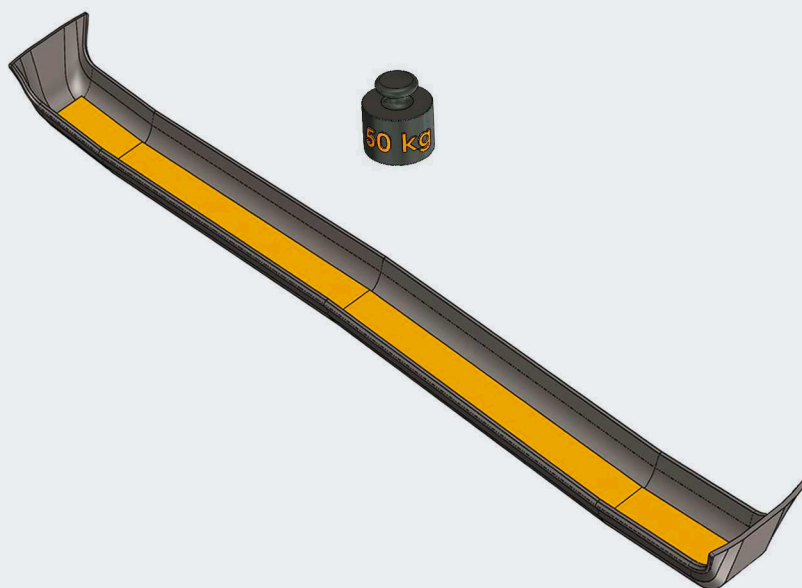
Oberfläche gleichmäßig mit 50 kg belasten.
