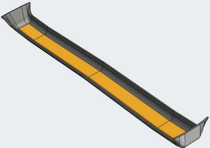
Die vorbereitete Klebemasse auf die Schwellensohle auftragen. Besteht die Sohle aus zwei Teilen, sollte außerdem die Stoßstelle mit Klebstoff versehen werden. Die benötigte Masse an Klebstoff hängt von der Oberflächenbeschaffenheit der Schwelle ab. Normalerweise werden pro Laufmeter Schwelle ca. 0,5 bis 1 kg Klebstoff benötigt.
