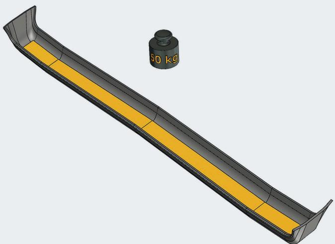
Die Schwellensohle wird zentrisch auf die Schwelle aufgebracht. Während des Aushärtezeitraums muss die gesamte Oberfläche gleichmäßig mit mindestens 50 kg belastet werden. Nach dem Kleben sollten keine Hohlräume mehr vorhanden sein, die nicht mit Klebstoff ausgefüllt sind. Die Klebstoff-Schicht sollte möglichst gleichmäßig sein und nicht mehr als 5 mm Dickenunterschied aufweisen, um die Steifigkeit des Gesamtsystems nicht zu beeinflussen.
