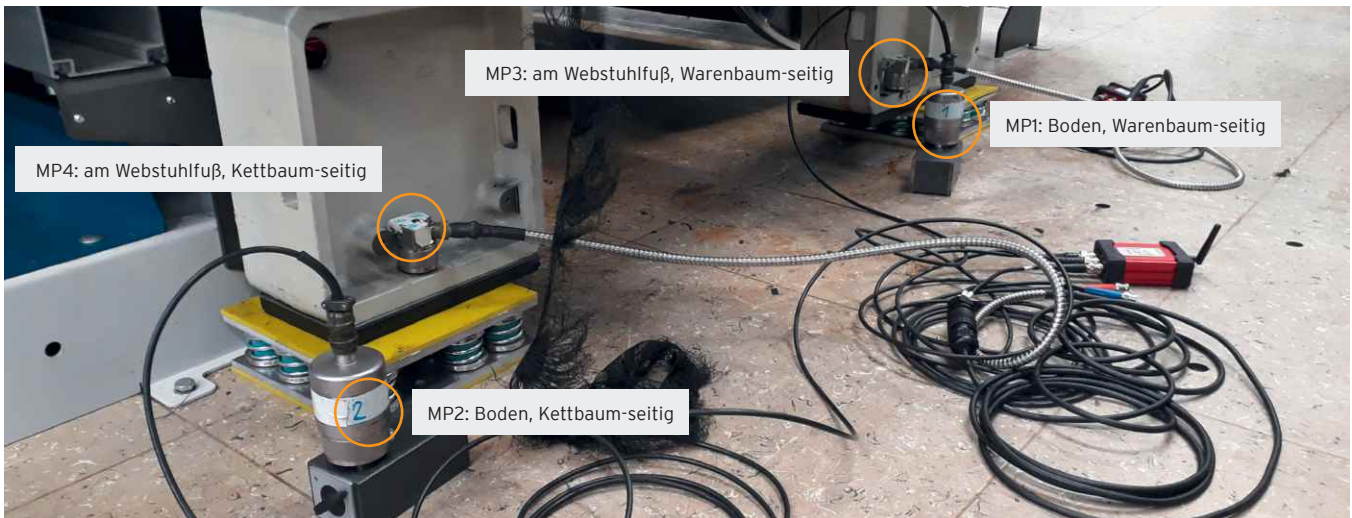
Versuchsaufbau: Anordnung der Messpunkte (MP) mit Beschleunigungssensoren
