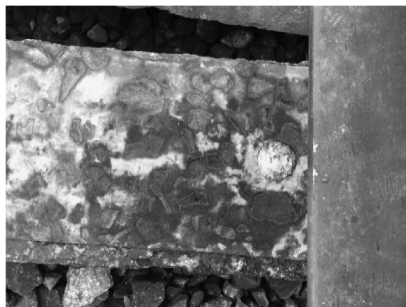
图4 翻转的弹性轨枕显示带有道砟印记的高接触面积
