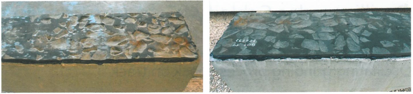
I Bild 13: Elastische und plastische Material-Eigenschaften von Schwellenbesohlungen kombiniert: Prognostizierte und gewünschte Schottereindrückungen unmittelbar nach dem Ausbau (links) und drei Wochen später – vollständige Rückstellung (rechts)
