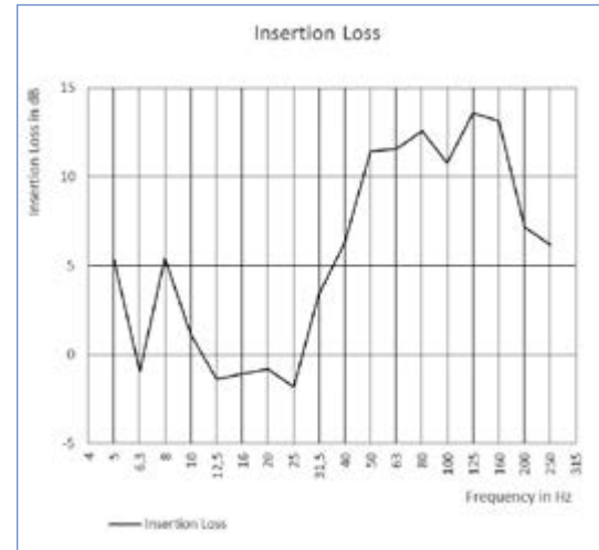
Slika 4. Izmjereni terčni pojas brzine vibracija bez podložaka kolosiječnih pragova SLS1308G i s njima (lijevo) te pripadno smanjenje razine buke zbog uvođenja barijere (Insertion Loss) kao razlikovni spektar (desno)
