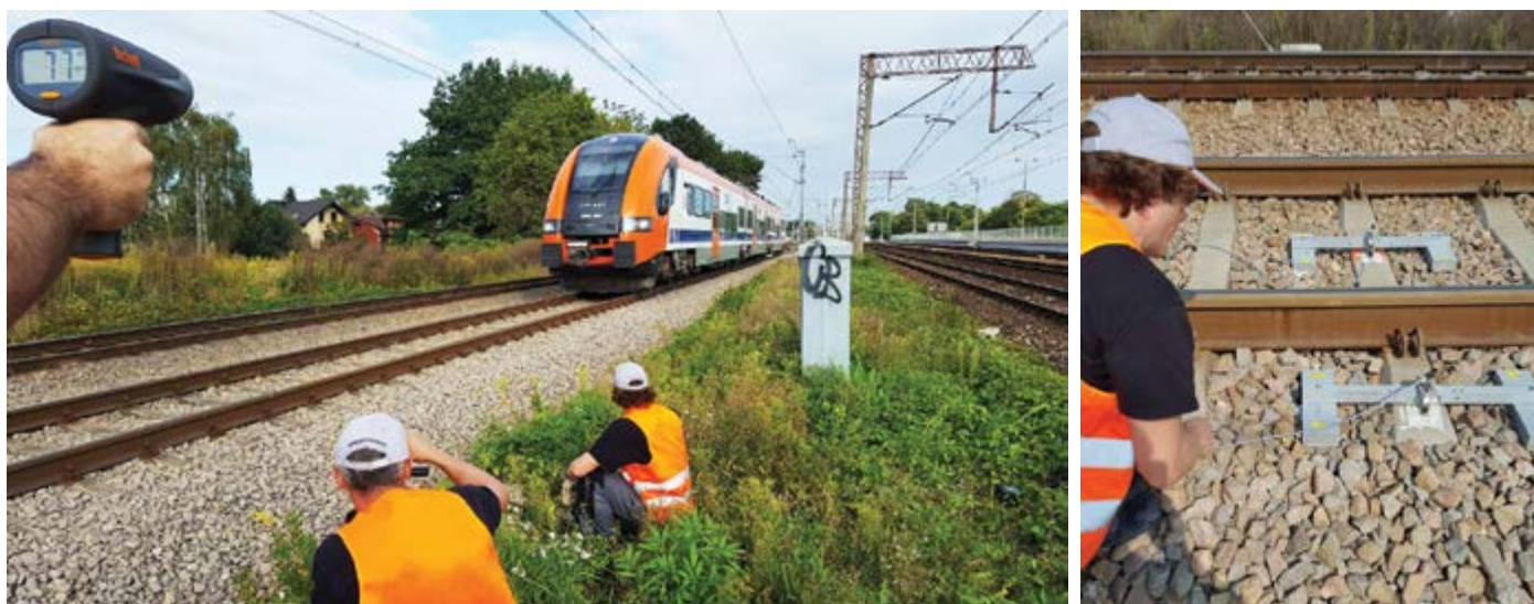
Slika 2. Mjerna mjesta na željezničkoj pruzi br. 118 bez ugrađenih podložaka kolosiječnih pragova i s njima
