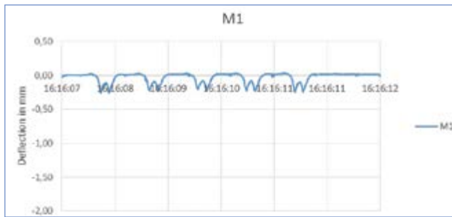
Slika 3: Progibi kolosiječnih pragova bez ugrađenih podložaka i s njima
