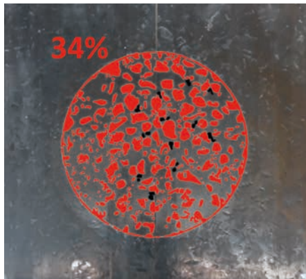
BILD 8: Einsenkungsmessungen am Übergang im Schwerlastverkehr (oben), Bestimmung der Kontaktfläche im Labor (unten)
