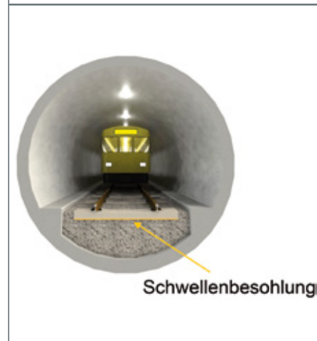
BILD 5: Schwellenbesohlungen im Schotteroberbau einer Tunnelröhre
