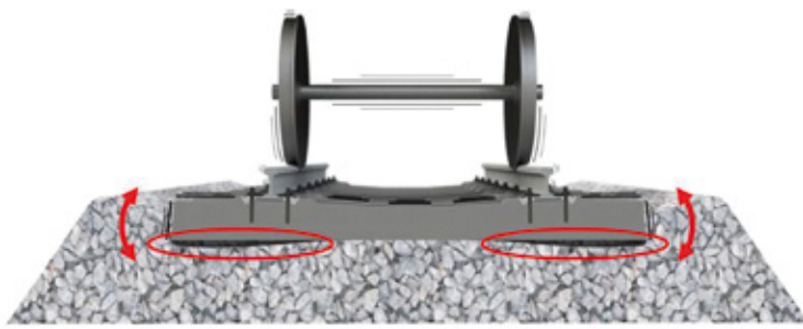
BILD 2: Hohllagenbildung nur unter unbesohlenen Betonschwellen. Solche Hohllagen werden durch Schwellenbesohlungen vermieden, was zu einer gleichmäßigeren Lastabtragung führt
