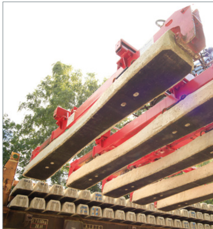
BILD 2: Hohllagenbildung nur unter unbesohlenen Betonschwellen. Solche Hohllagen werden durch Schwellenbesohlungen vermieden, was zu einer gleichmäßigeren Lastabtragung führt
