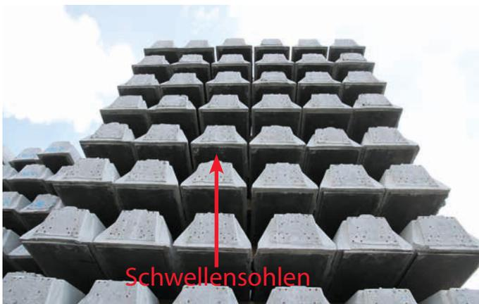
BILD 6: Betonschwellen mit Schwellensole SLB2210G
