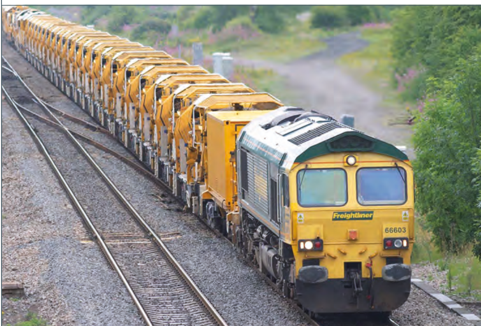
BILD 1: Schwerlastverkehr verursacht eine hohe Beanspruchung des Schotteroberbaus
