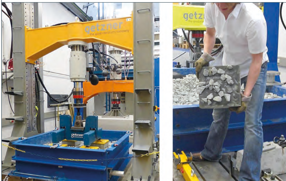
BILD 4: Simulation der Schwerlastbeanspruchungen im Schotterkasten des Großprüfstandes (links). Nach Versuchsende bleiben die Schotterkörner im speziellen PUR-Besohlungsmaterial haften (rechts)
