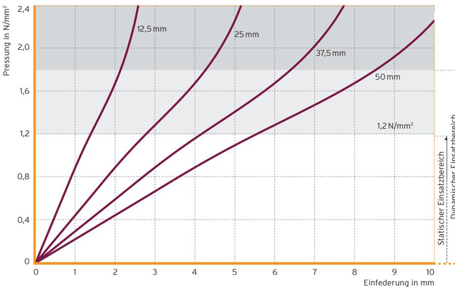
Abb. 1: Quasistatische Federkennlinie für verschiedene Lagerdicken
