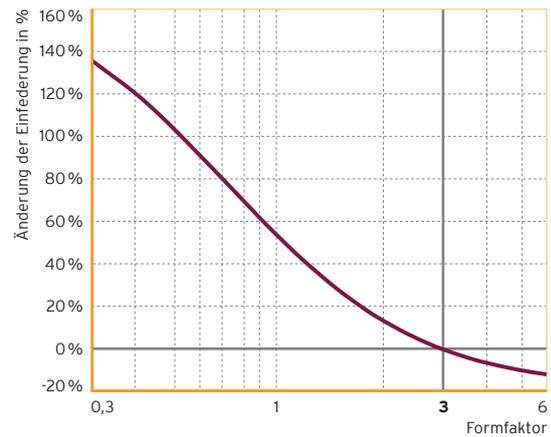
Abb. 6: Einfederung<sup>4</sup> in Abhängigkeit des Formfaktors
