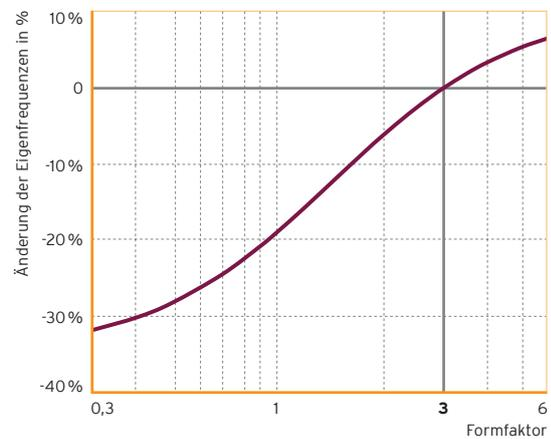
Abb. 8: Eigenfrequenz<sup>4</sup> in Abhängigkeit des Formfaktors
