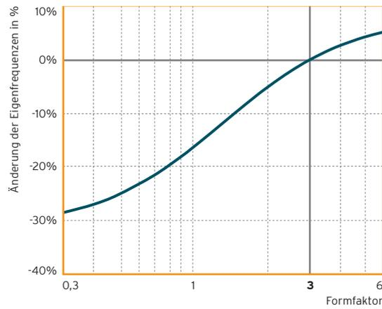
Abb. 8: Eigenfrequenz<sup>4</sup> in Abhängigkeit des Formfaktors
