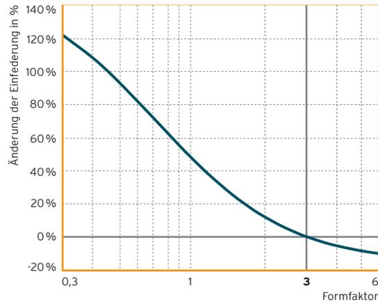
Abb. 6: Einfederung<sup>4</sup> in Abhängigkeit des Formfaktors
