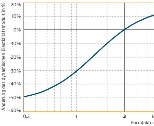
Abb. 7: Dynamischer Elastizitätsmodul<sup>4</sup> bei 10 Hz in Abhängigkeit des Formfaktors
