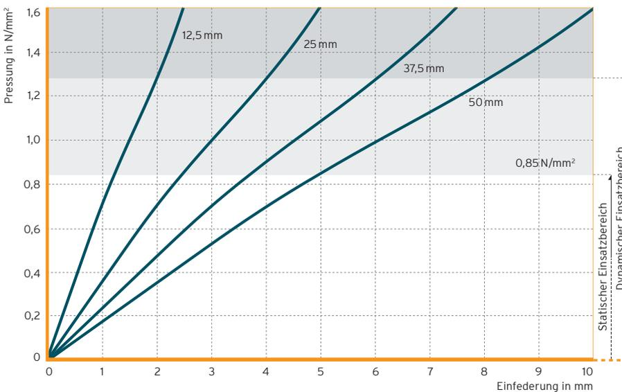
Abb. 1: Quasistatische Federkennlinie für verschiedene Lagerdicken
