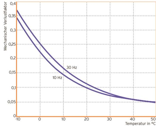
DMA-Untersuchungen (Dynamic Mechanical Analysis); Messungen im linearen Bereich der Federkennlinie, bei geringer Pressung
