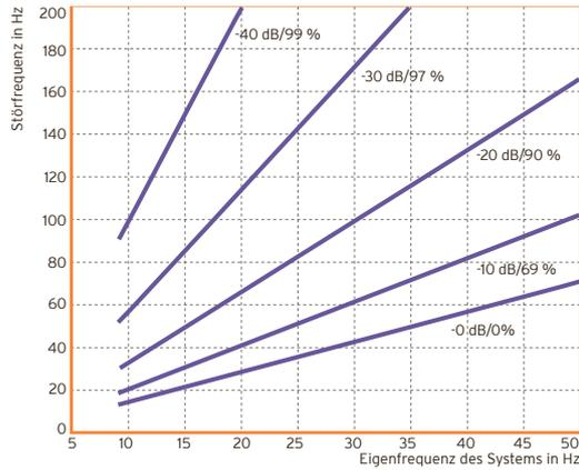
Verminderung der Übertragung mechanischer Schwingungen durch den Einbau einer elastischen Lagerung aus Sylodyn® NF
