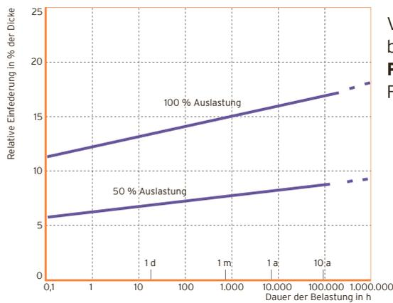
Verformungszunahme unter gleich bleibender Druckbelastung
