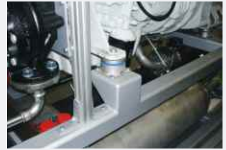
Pumpe mit Isotop® DZE zur Kompensation hoher dynamischer Betriebskräfte
