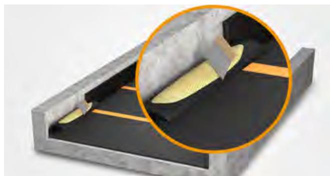
Nach Abschluss der Installation sollten die verklebten Mattenstöße visuell überprüft werden. Nicht korrekt verklebte Fugen können Schallbrücken verursachen, wodurch die Vibrationsisolierung beeinträchtigt oder sogar komplett unwirksam werden kann. Aus diesem Grund empfehlen wir, das gesamte MFS zusätzlich mit einer transparenten PE-Folie abzudecken. Das MFS darf nicht mit Fahrzeugen befahren werden.
