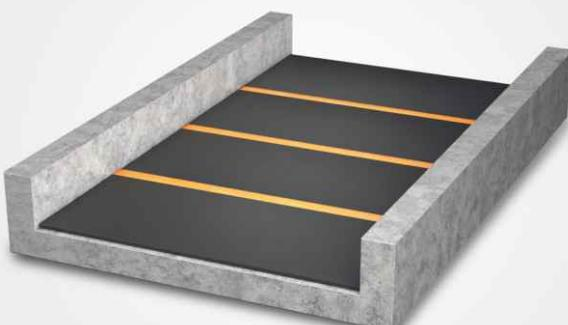
Nicht korrekt versiegelte Fugen können Schallbrücken verursachen. Die Vibrationsisolierung könnte aus diesem Grund sogar komplett versagen.
