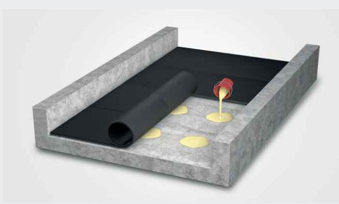
Der Klebstoff wird punktuell aufgetragen, um eine einwandfreie Entwässerung unter der USM zu ermöglichen.
