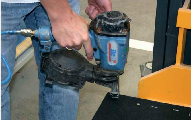
Eine alternative Methode zur Befestigung mit Klammer ist die Verwendung von Nägeln. Um das Material nicht zu beschädigen und die Wirkungsweise zu gewährleisten, wird empfohlen, Nägel mit großen Kopfdurchmessern zu verwenden.
