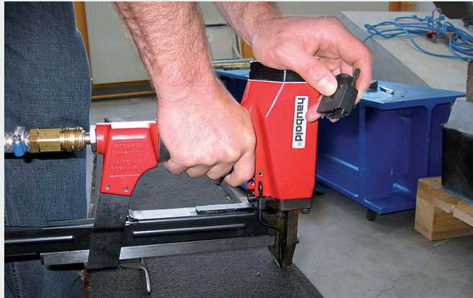
Die Klammer können mittels eines pneumatischen handelsüblichen Klammer- oder Nagelgeräts befestigt werden.
